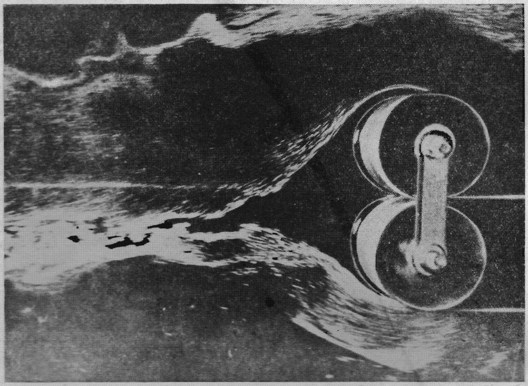
Abb. 3. Strömung um zwei rotierende Zylinder («Schiff ohne Widerstand»)
